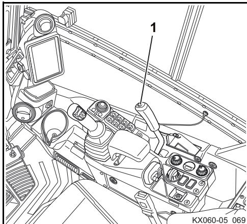
Deux signaux sonores retentissent et le témoin (1) passe au symbole de vitesse rapide. Un nouvel actionnement du bouton de vitesse rapide fait passer la machine à la vitesse normale et un seul signal sonore retentit.
