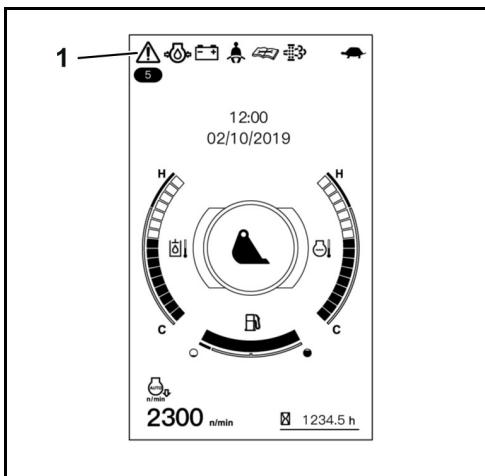
Au démarrage de la régénération automatique du filtre à particules, un message comme celui sur l'illustration de droite apparaît à l'écran. Le voyant d'avertissement clignote en jaune et un signal sonore retentit toutes les 60 secondes.
