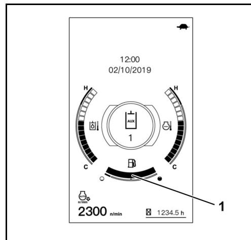
Lorsque le message « Refaire le plein » est affiché et que le témoin d'avertissement (1) clignote de couleur jaune, il ne reste plus qu'une faible quantité de carburant dans le réservoir. Ravitailler la machine en carburant (page 149).
