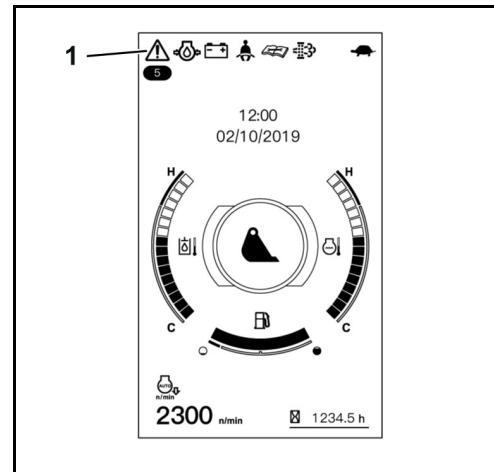
Si au cours du fonctionnement la pression d'huile moteur devient insuffisante, il faut immédiatement arrêter le moteur. Le témoin de pression d'huile moteur (2) s'allume, le témoin d'avertissement (1) clignote de couleur rouge et le message montré sur l'illustration de droite est affiché.
