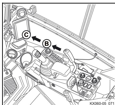
La lame reste en position de flotteur jusqu'à ce que le levier de commande de lame soit replacé en position neutre.
