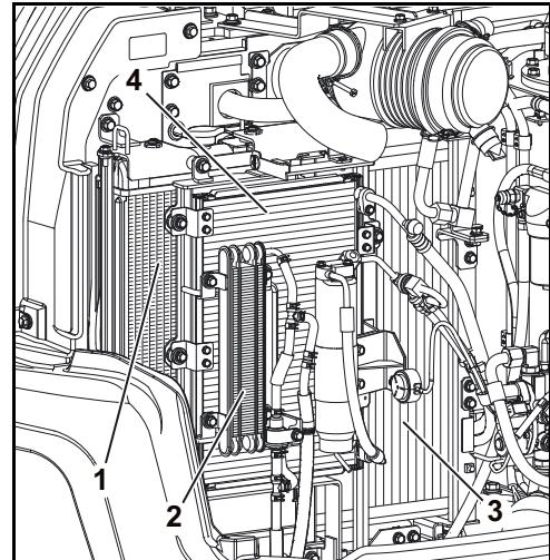
Après le nettoyage, contrôler si le radiateur/le refroidisseur n'est pas endommagé.
