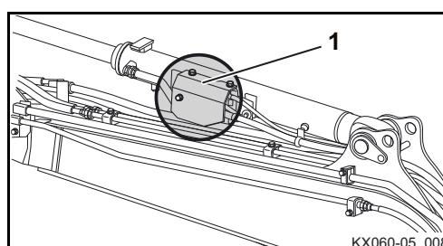
Toute manipulation ou réparation des clapets de sécurité est interdite. Ils ne doivent être remplacés que sous forme d'ensemble complet, par un concessionnaire KUBOTA.
