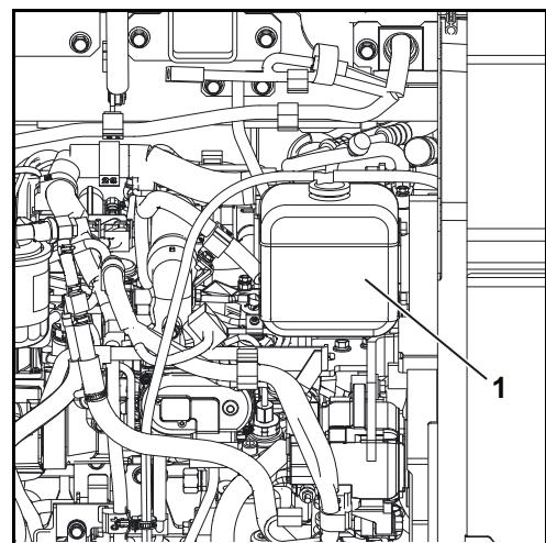
Si le vase d'expansion avait été complètement vidé, contrôler le niveau du liquide de refroidissement dans le radiateur.
