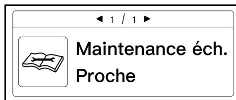
Si le moment d'un intervalle de maintenance est atteint ou dépassé, le message « Notification de maintenance éch. » apparaît sur l'afficheur.
