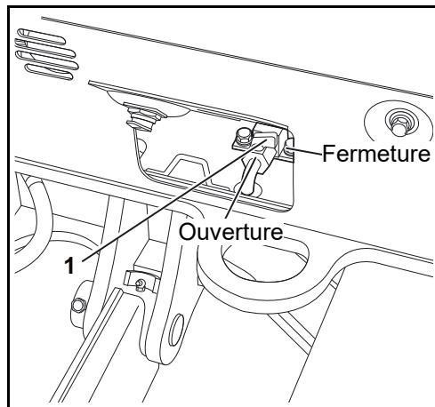
**Conduites de carburant et flexibles d'aspiration d'air - Contrôle**
