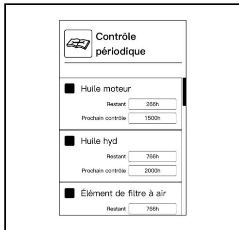
Les points de maintenance illustrés dans le tableau suivant sont réglés dans l'affichage des intervalles de maintenance.
