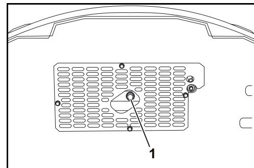
Supposons que le cache (1) ait été retiré sous le moteur à des fins de maintenance. Avant de réinstaller le cache, faire passer le flexible de vidange (2) du carter d'huile moteur (3) par l'ouverture dans le capot.
