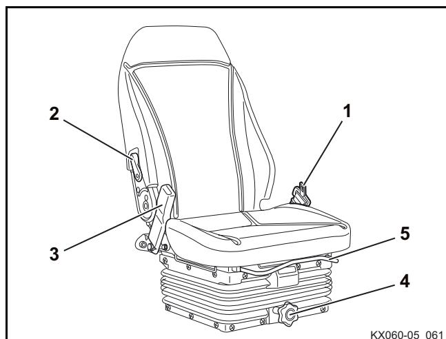
Siège à suspension mécanique
