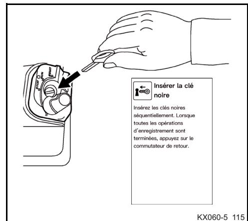
7. Au bout de quelques instants, le message « Retirer clé noire » est affiché. Ce message signale que la clé noire a été enregistrée et activée pour ce véhicule.
