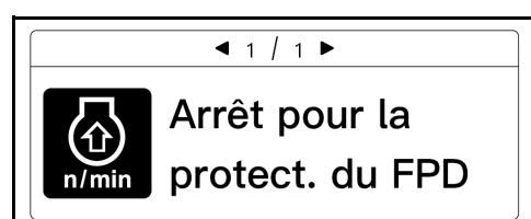
La régénération du filtre à particules est réalisée. La puissance du moteur est réduite à 50 %.
