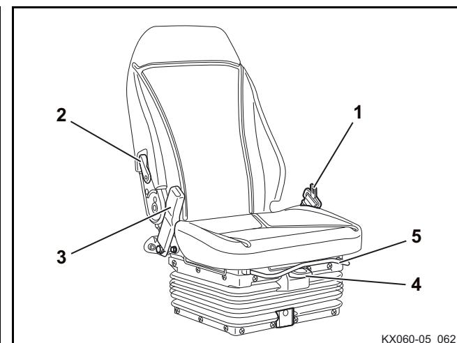
Siège à suspension pneumatique (en option)
