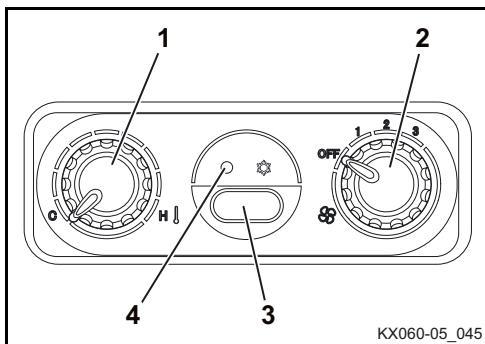
L'interrupteur de climatisation permet la mise en marche de la climatisation lorsque le contacteur de démarrage se trouve en position RUN et que le ventilateur est en marche. Le fonctionnement de la climatisation (en option) est confirmé par le témoin.
