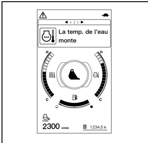
En cas de température excessive du liquide de refroidissement, faire tourner la machine au ralenti pour permettre le refroidissement. Le message montré sur l'illustration de droite est alors affiché.
