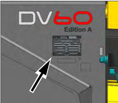
Fig. 4 Plaque signalétique de la machine
