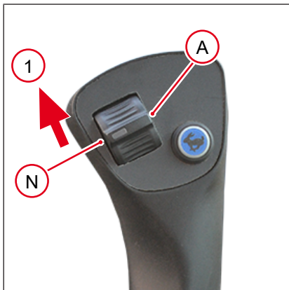
Fig. 105: Contrôle fonctionnel détecteur de présence du siège
