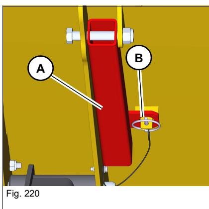
Le support de maintenance **A** est fixé en-dessous de la benne. Déposer la goupille **B**.
