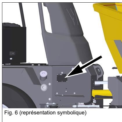
La plaque signalétique de la machine se trouve à droite sur le châssis.
