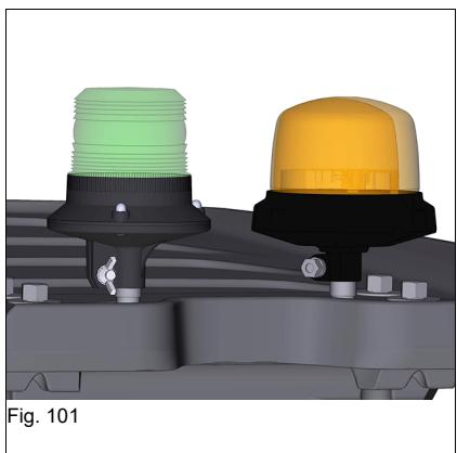
2. Démonter les gyrophares, dévisser les vis et mettre de côté les gyrophares.
