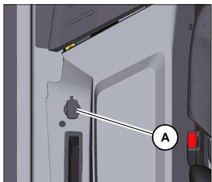
Une prise électrique 12 V **A** se trouve dans la cabine, du côté gauche.
