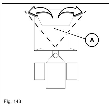
La machine est équipée d'une direction articulée. Le volant actionne un vérin hydraulique qui oriente l'unité benne **A**.
