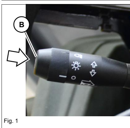
Appuyer sur la touche **B** sur l'interrupteur de la colonne de direction (standard pour 3TNV88 ou 3TNV76 et avec pack route pour 403J-E17T).
