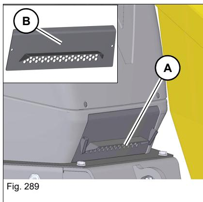
Nettoyer la face extérieure de la grille **A** quotidiennement. Si nécessaire, déposer le cache **B** et nettoyer le filtre.
