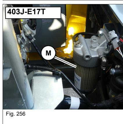
3TNV88 : le filtre principal est situé à gauche dans le compartiment moteur, à côté du réservoir de diesel.
