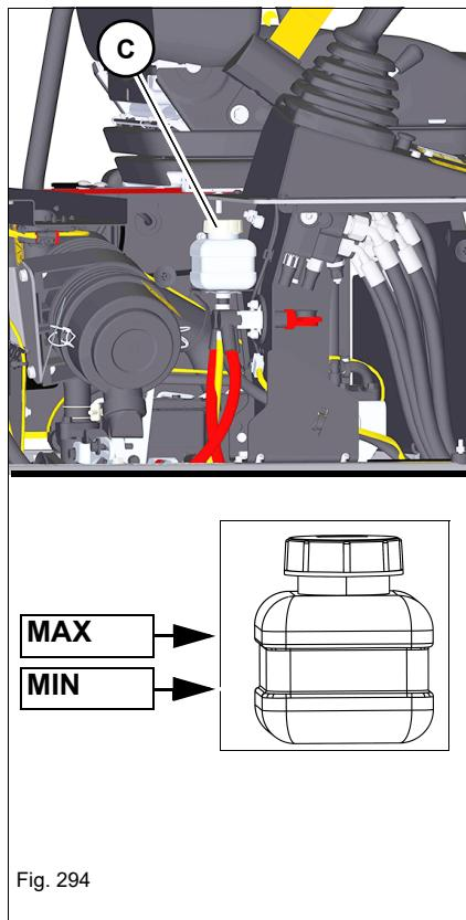
Le niveau du liquide de frein dans le réservoir **C** doit au minimum atteindre la marque MIN. Contrôler chaque jour le niveau du liquide et en rajouter si nécessaire – *voir chapitre « 7.3 Fluides et lubrifiants » en page 7-16.*
