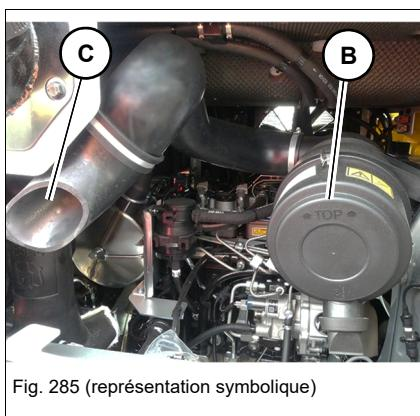
4. Ouvrir la trappe de maintenance 4, contrôler l'admission d'air **C** et la nettoyer si nécessaire.
