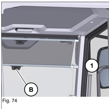
Tirer le store pare-soleil vers le bas à l'aide de la languette **B** et l'accrocher à gauche et à droite de la vitre avant en position **1** ou **2**.
