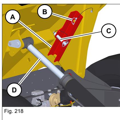
Le support de maintenance **A** est fixé en-dessous de la benne. Sortir la goupille **B** et l'axe **C**.
