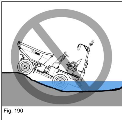
Lorsque la machine sort de l'eau, veiller à ce que l'AR de la machine ne soit pas immergée dans l'eau, notamment le système d'échappement.
