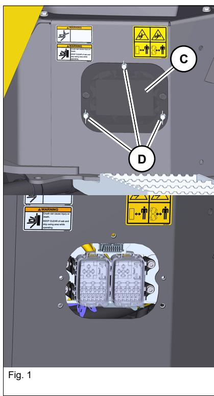
La boîte à fusibles se trouve derrière la trappe de maintenance 2 (C).
