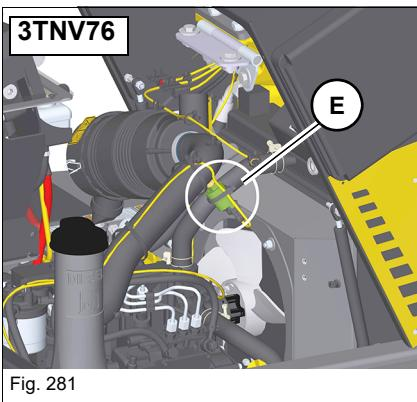
6. Vérifier que les câbles et connecteurs de l'indicateur d'encrassement **E** ne sont pas endommagés.
