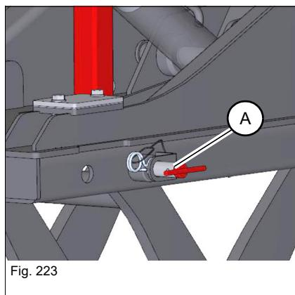
La cheville **A** qui empêche les ciseaux de s'abaisser se trouve du côté droit de la machine. La barre d'appui de maintenance **B** est fixée en dessous de la benne.
