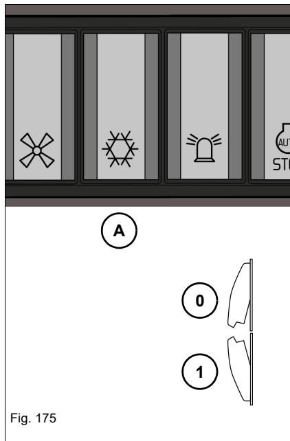
L'interrupteur **A** se trouve sur le panneau d'interrupteurs avant.
