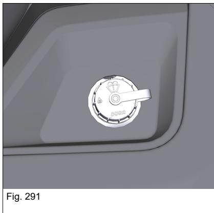
Le réservoir de solution de nettoyage du système lave-glace se trouve du côté droit, à l'arrière dans la cabine.
