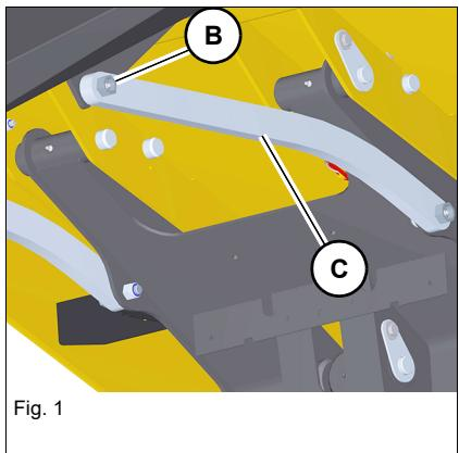
3. Démonter les vis et écrous **B**.
