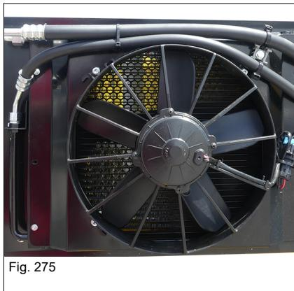
Le condenseur de climat se trouve sur l'arrière de la trappe de maintenance 3.
