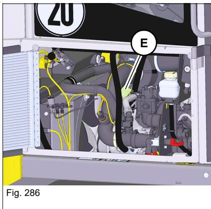
5. Vérifier que les câbles et connecteurs de l'indicateur d'encrassement **E** ne sont pas endommagés.
