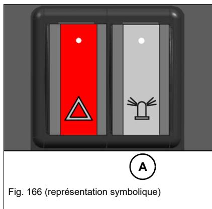
L'interrupteur **A** se trouve sur le panneau d'interrupteurs central (arceau de sécurité) ou sur le panneau d'interrupteurs avant (cabine).
