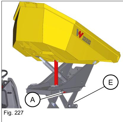
4. Les ciseaux **E** doivent être entièrement relevés pour pouvoir les verrouiller à l'aide de la cheville – *voir chapitre « Lever et abaisser les ciseaux (Gyrapenne à déversement en hauteur) » en page 5-31.*
