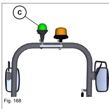
Le gyrophare vert **C** s'allume lorsque la languette est enclenchée dans la boucle de la ceinture – *voir « Ceinture de sécurité » à la page 4-10.*
