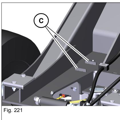
Le support d'entretien **A** doit être placé entre les plaques de délimitation **C**.
