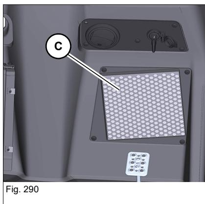
Nettoyer la face extérieure de la grille **C** quotidiennement, et si nécessaire la déposer et nettoyer le filtre.
