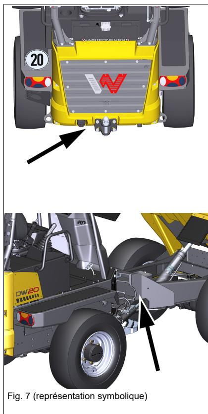
Le numéro de série de la machine est également gravé dans le châssis aux endroits marqués.
