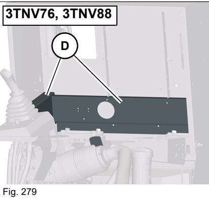
5. Contrôler le canal d'air **D** à l'intérieur du capot moteur et le nettoyer si besoin est.
