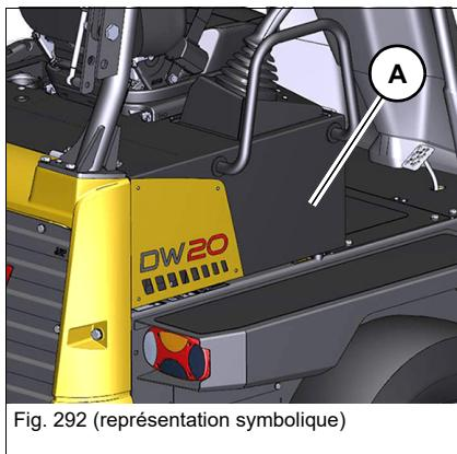
Le réservoir de liquide de frein se trouve du côté droit de la machine, sous le capot-moteur **A** ou derrière la trappe de maintenance 3 (**B**).
