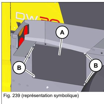
La batterie se trouve derrière la trappe de maintenance 1 (A).
