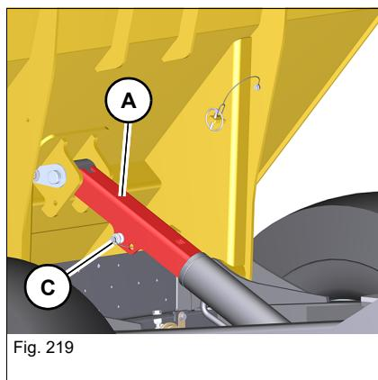
Poser le support d'entretien **A** sur la tige **D** du vérin de cavage et le monter avec l'axe **C**.
