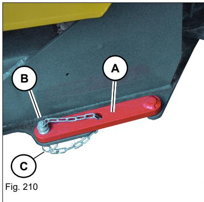
Le support du joint articulé **A** empêche le mouvement d'articulation de la machine.
