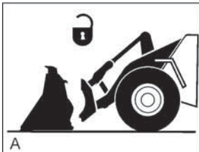
A Broches de verrouillage du porte-outil en position déverrouillée
