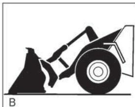
B Basculer vers l'avant d'environ 15° et accrocher le porte-outil dans les points de fixation supérieurs de l'outil
