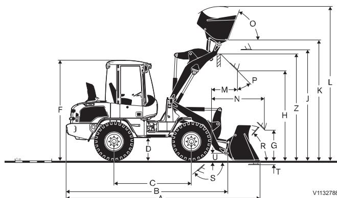
L35G avec tringlerie à barre en Z, porte-outils en Z et pneus 405/70 R20
