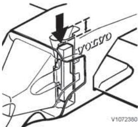
Le dispositif de verrouillage doit se trouver juste en dessous du trait de repère.
