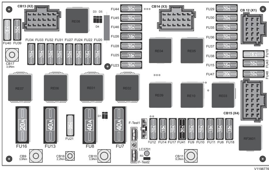
Relais et fusibles sur carte électronique, module électrique central (ancienne version)
