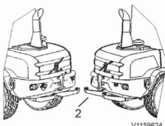
Monter la saleuse sur le support arrière (2). Brancher les flexibles hydrauliques et le connecteur électrique, voir également 158.
