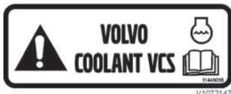
Le liquide de refroidissement Volvo VCS est jaune et un autocollant près du point de remplissage indique que c'est ce liquide qui est utilisé dans le système (voir dessin).
