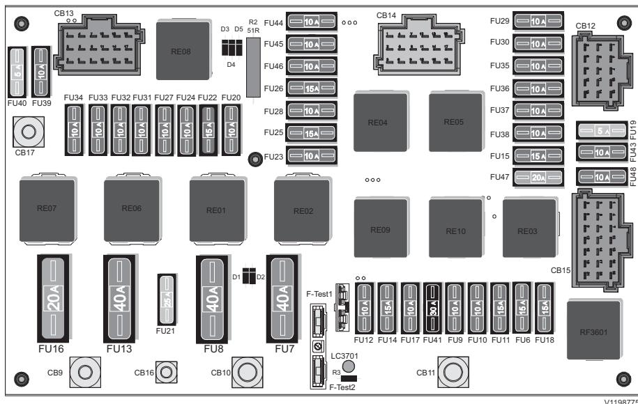
Relais et fusibles sur carte électronique, module électrique central (nouvelle version)
