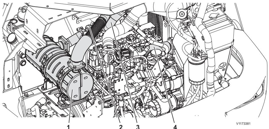
Surfaces chaudes dans le compartiment moteur (moteur D3.3M)
