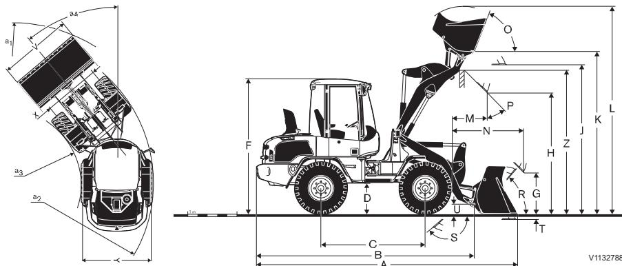
L30G avec tringlerie à barre en Z, porte-outils en Z et pneus 365/80 R20
