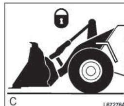
C Lever, basculer en arrière jusqu'à ce que l'outil soit de niveau et verrouiller avec les broches de verrouillage du porte-outil
