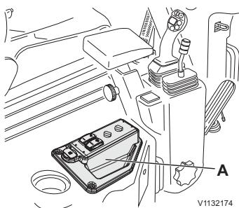
A Chauffage et ventilation à commande mécanique
