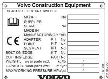
Doit par exemple être fixé sur le godet, avec des pièces en mouvement à commande hydraulique (fonction de déversement latéral et déversement haut) et le godet avec pouce (bras de serrage) (marquage CE)
