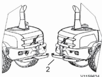
Monter la saleuse sur le support arrière (2). Brancher les flexibles hydrauliques et le connecteur électrique, voir également 158.
