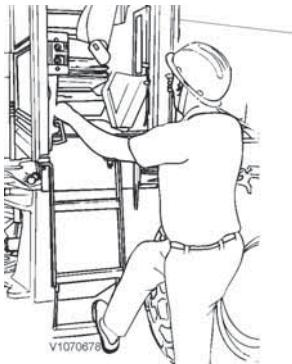
■ Pour accéder à la machine ou pour en descendre, utiliser les marches et les poignées. Toujours utiliser trois points d'appui, c.-à-d. deux mains et un pied ou deux pieds et une main. Toujours rester face à la machine; ne pas sauter !
