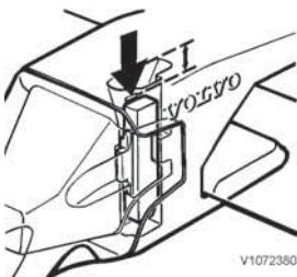
Le dispositif de verrouillage doit se trouver juste en dessous du trait de repère.
