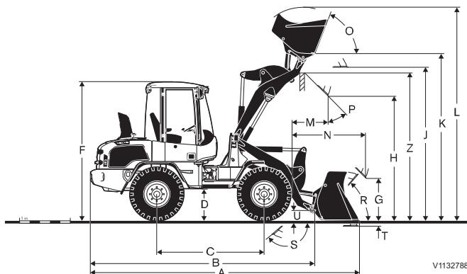
L30G avec tringlerie à barre en Z, porte-outils en Z et pneus 365/80 R20
