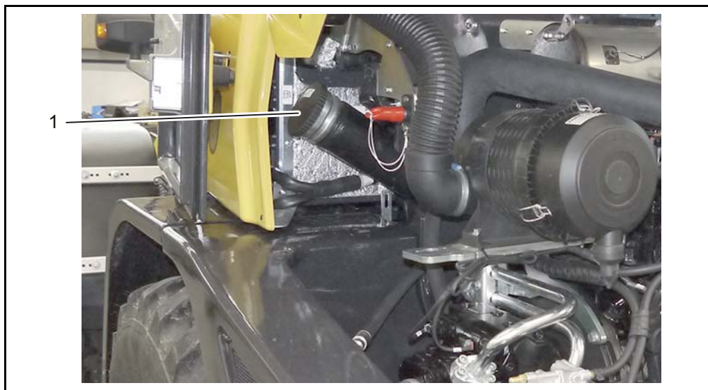
Fig. 6-13 Orifice de remplissage du carburant
