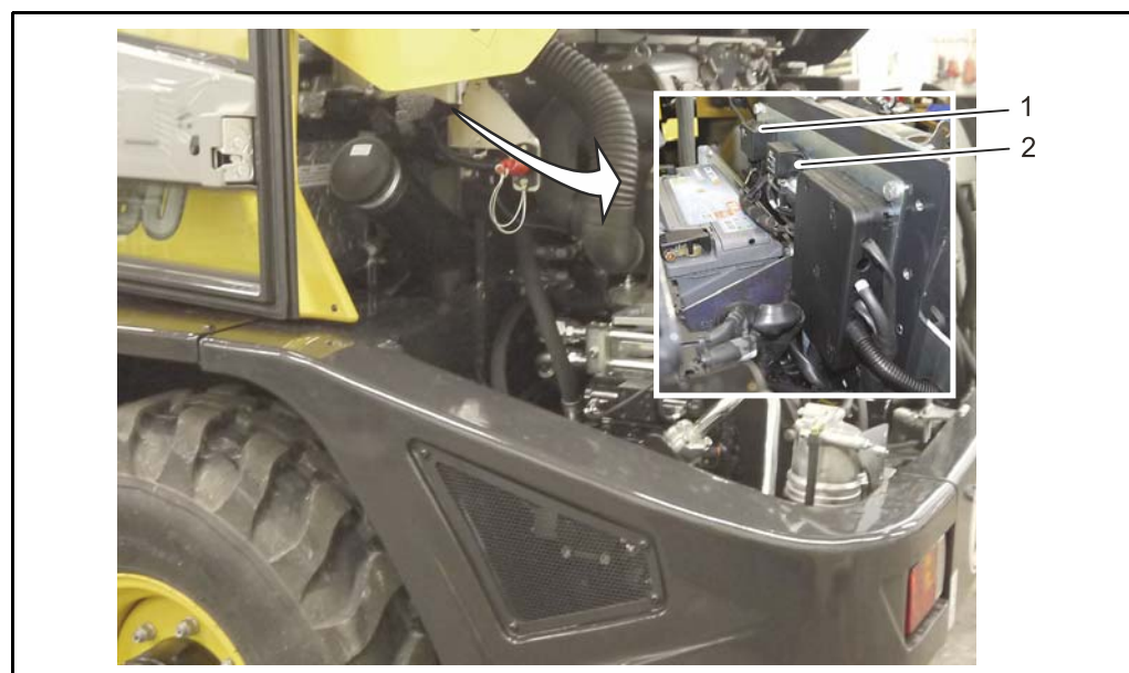
Fig. 5-10 Relais de démarrage
