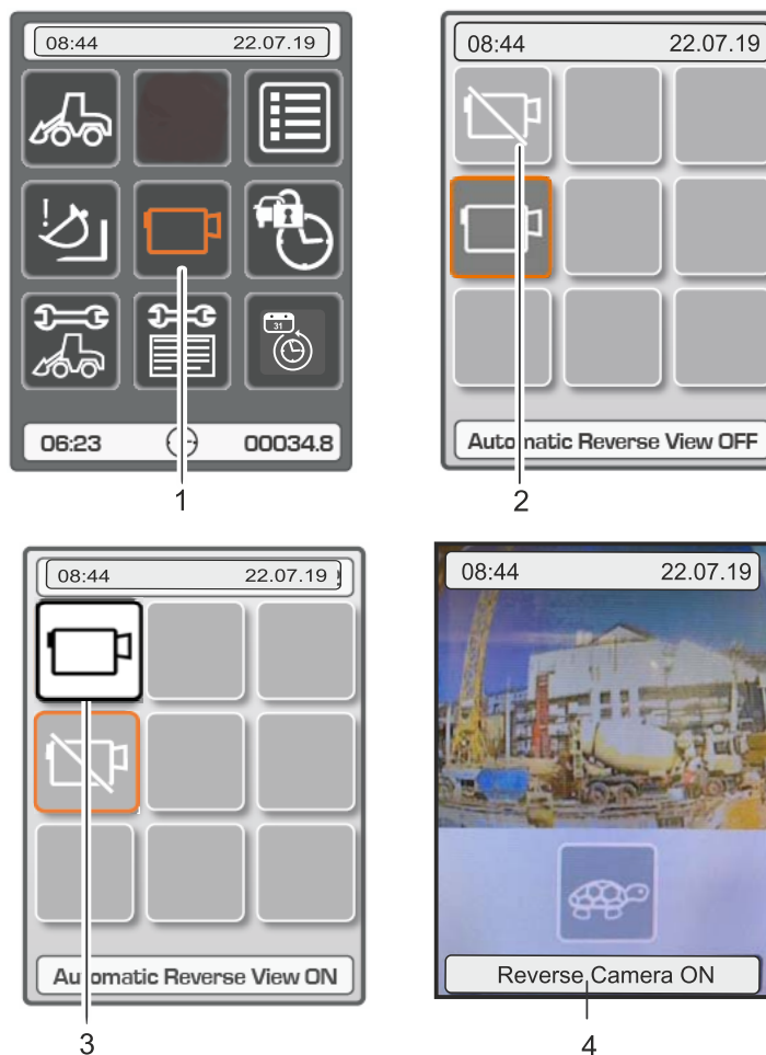
Fig. 5-42 Menu paramétrage caméra de recul
