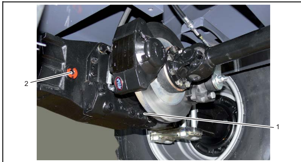
Fig. 6-25 Différentiel de l'essieu avant
