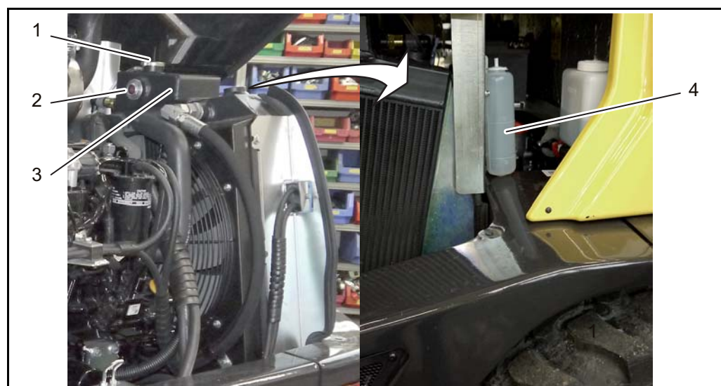
Fig. 6-7 Contrôle du niveau de réfrigérant
