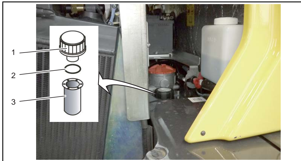
Fig. 6-24 Remplacement du filtre d'aération
