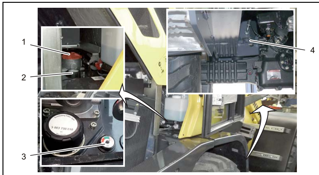
Fig. 6-21 Réservoir d'huile hydraulique
