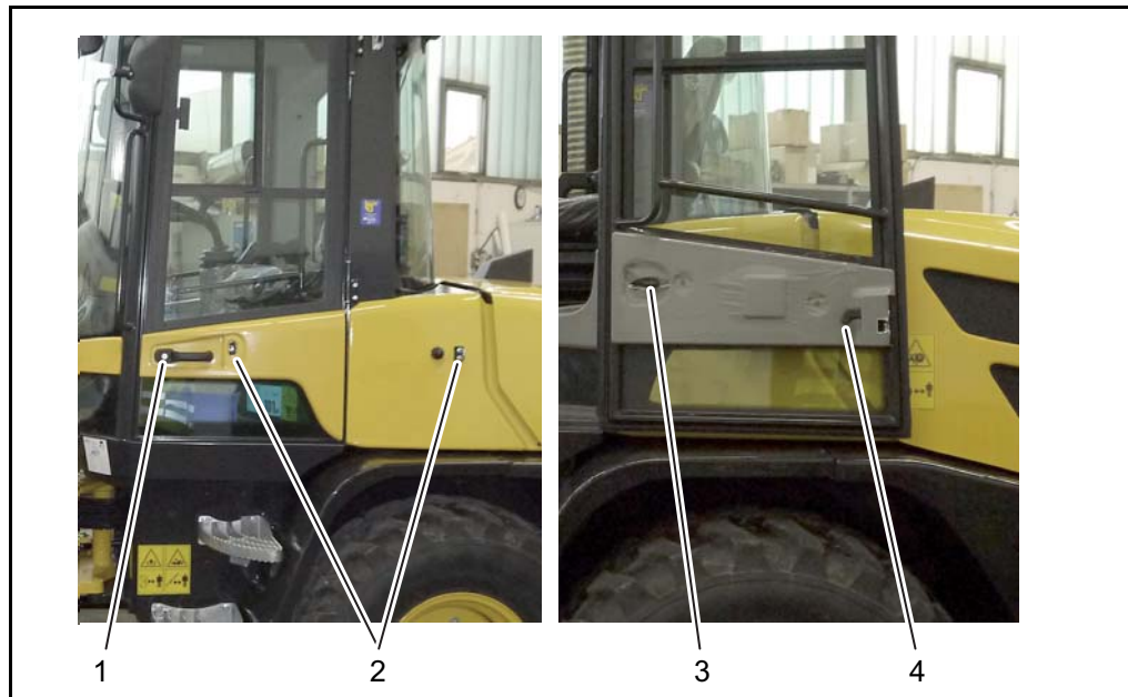
Fig. 7-8 Verrouillage de portière
