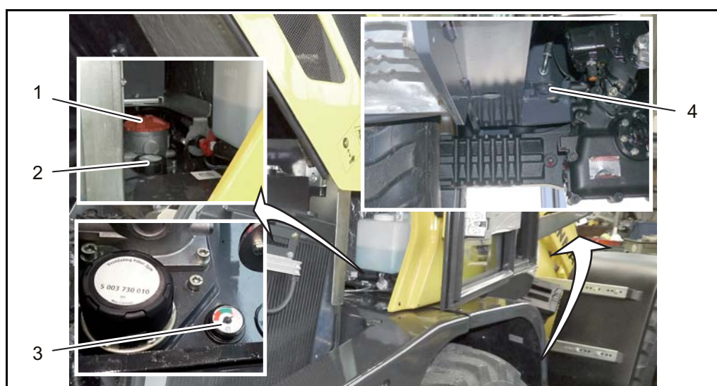
Fig. 6-22 Réservoir d'huile hydraulique
