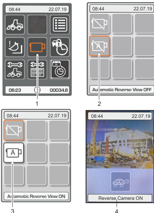
Fig. 5-43 Menu paramétrage caméra automatique de recul
