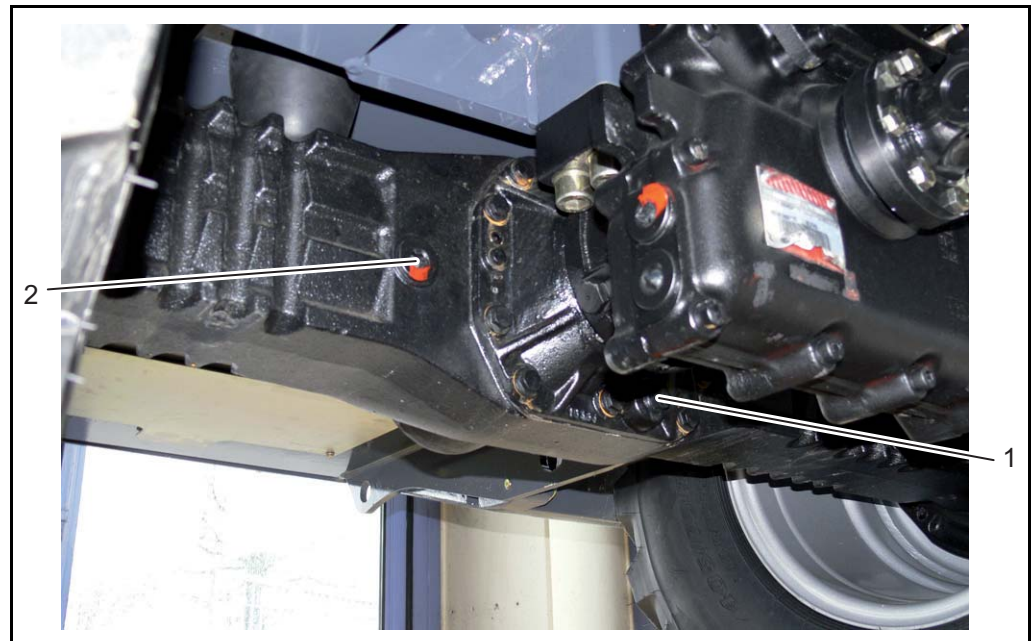
Fig. 6-26 Différentiel de l'essieu arrière
