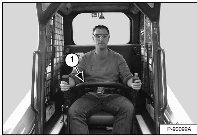
Le dispositif de verrouillage Bobcat (BICS™) comprend un arceau de siège pivotant avec accoudoirs (1) [Figure 18]. L'utilisation de l'arceau de siège est commandée par l'opérateur.
