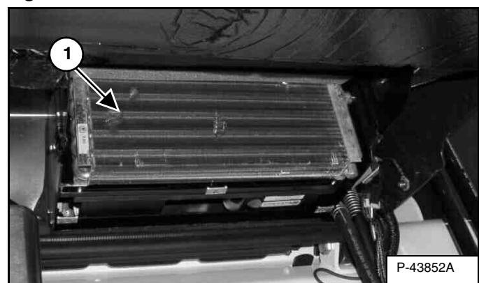
Nettoyez le faisceau du chauffage (1) avec de l'eau ou de l'air à basse pression pour retirer tous les débris [Figure 141].
