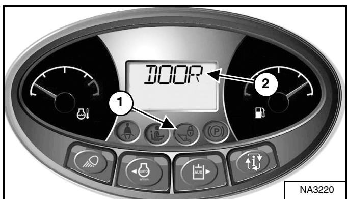
Le témoin de LEVAGE ET CAVAGE (1) [Figure 128] est ÉTEINT lorsque la porte est fermée, que le contacteur à clé est placé sur la position MARCHE ou que le bouton MARCHE / ENTRÉE est enfoncé, que l'arceau de siège est abaissé et que le bouton APPUYER POUR UTILISER LA CHARGEUSE est enfoncé.
