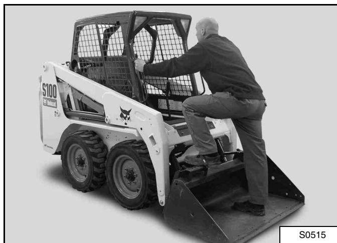
Utilisez les marchepieds du godet ou de l'accessoire, les mains courantes et l'antidérapant (sur les bras de levage et le châssis de la chargeuse) pour monter et descendre de la chargeuse en maintenant en permanence un contact en trois points [Figure 70]. Ne sautez pas.
