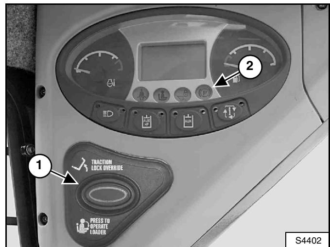
(Fonctionne uniquement lorsque l'arceau de siège est relevé et que le moteur tourne). Le bouton DÉVERROUILLAGE DE LA TRANSMISSION (1) [Figure 21] se trouve sur le tableau de bord gauche. Elle permet de déplacer la chargeuse en marche avant et arrière à l'aide des Commandes de direction en cas d'utilisation de la pelle rétro ou pendant un entretien de la chargeuse.
