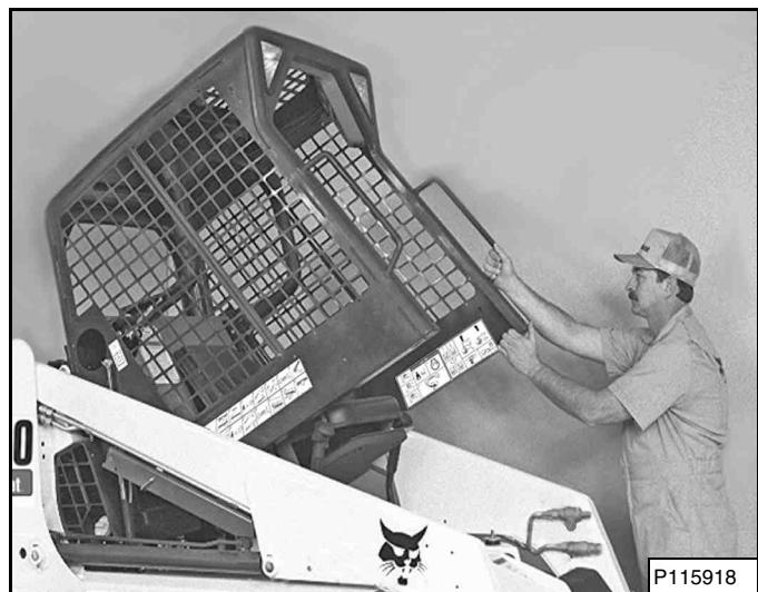
Levez la cabine lentement par les mains courantes et le bas de la cabine jusqu'à ce qu'elle soit complètement levée et que son mécanisme de verrouillage s'enclenche [Figure 131].
