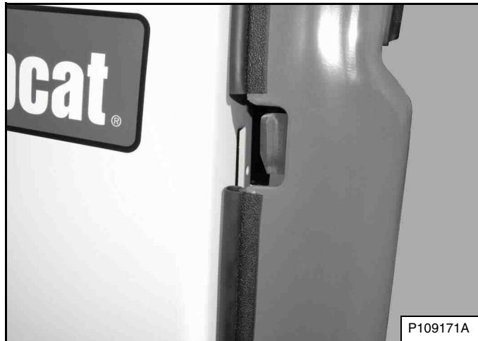
Passez la main dans l'encoche sur le côté gauche de la porte arrière et tirez le loquet [Figure 134]. Ouvrez la porte arrière en tirant dessus.
