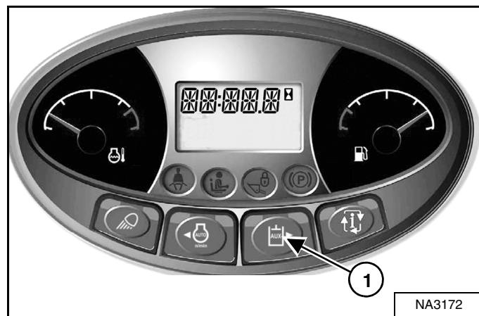
Appuyez sur le bouton des auxiliaires hydrauliques (1) [Figure 64].
