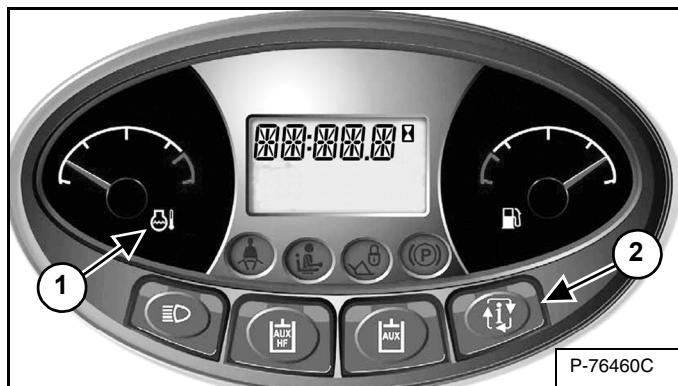
Contrôlez régulièrement les cadrans de température et de niveau de carburant ainsi que les témoins BICS™ (tous doivent être éteints pour utiliser la chargeuse) [Figure 88].
