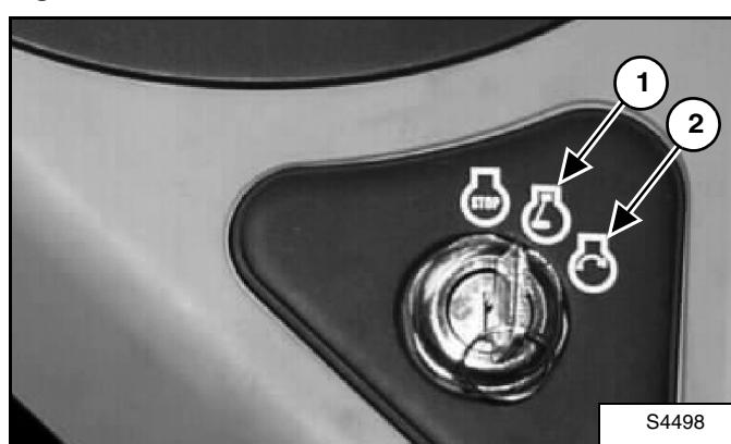
Tournez le contacteur à clé sur la position MARCHE (1) [Figure 79]. Les témoins du tableau de bord gauche s'ALLUMENT brièvement tandis que le tableau de bord / système de surveillance exécute un test automatique.
