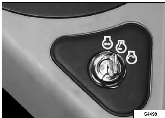
Cette machine peut être équipée d'un tableau standard à contacteur à clé [Figure 11].
