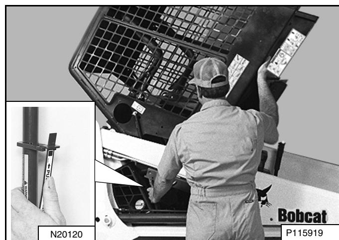
Tirez vers le bas la partie inférieure de la cabine jusqu'à ce qu'elle se cale sur le mécanisme de verrouillage [Figure 132].
