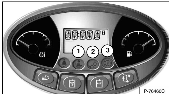
Les trois témoins (1, 2, et 3) [Figure 19] du tableau de bord gauche doivent être ÉTEINTS pour utiliser la machine avec toutes ses fonctions.
